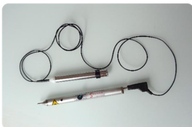
Veilige verbindingkabel voor verbinding van PS 3 en Silberbauer CL-laser
