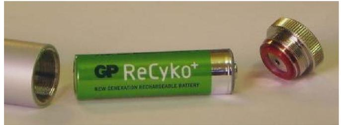
Mettre le commutateur rotatif 1 (6) en position « Arrêt ». Ouvrir le couvercle de la pile (10) à l'arrière du laser et insérer une pile ou une batterie dans le tube, pôle moins en premier ; refermer le couvercle de la pile et le tourner à fond dans le sens des aiguilles d'une montre.
